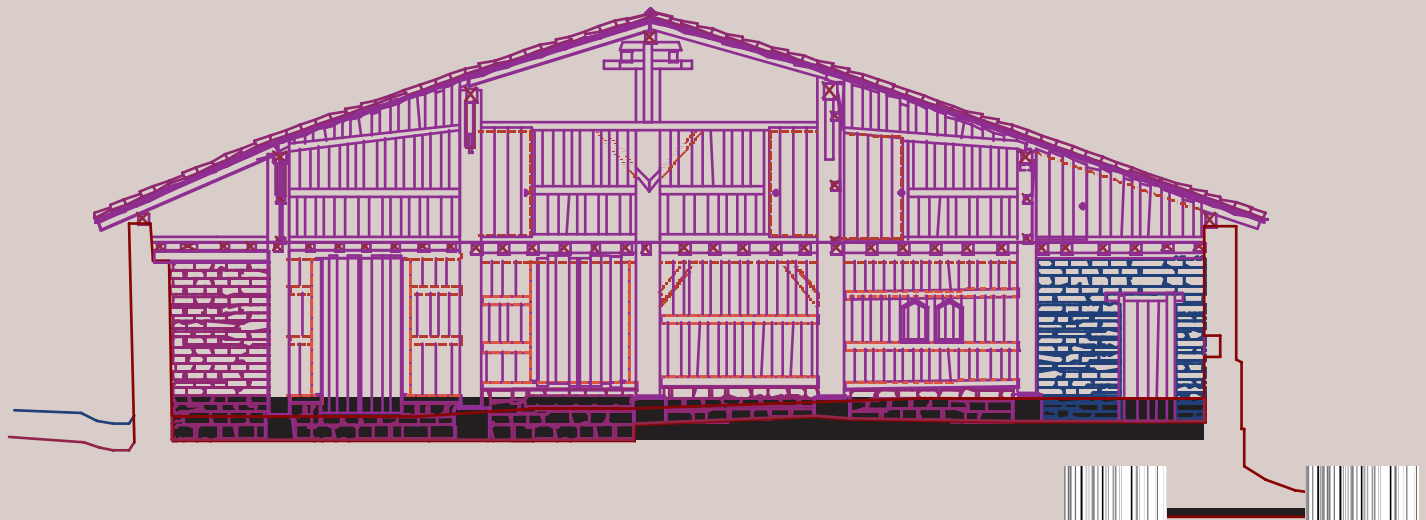
Zeharkako ebakidura lehen hormartean. XVI. mendeko baserriaren fatxada nagusia osatzen du. Handitze lanetako horma-atalak harlanduarengatik nabarmentzen dira.
